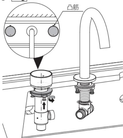
**!** 安装时，请确保旋钮上的凸筋正对墙面。
