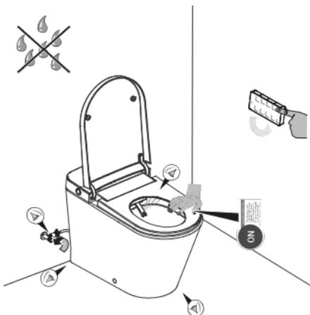
**!** 检查过程中, 请注意遮挡喷嘴, 以免水直接喷向人体。
