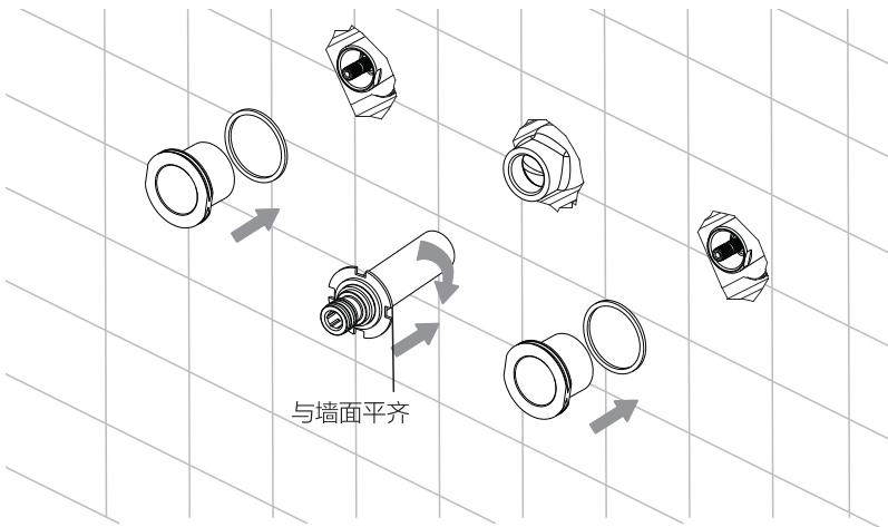
6. 取出水嘴组，插入预埋阀体出水口（插入时注意保护水嘴口上的密封圈），调整水嘴组方向，将底座向内推至紧贴墙面，再用附带的内六角扳手旋紧螺丝。
