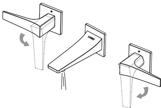
**⚠ 注意：** 为防止烫伤，龙头开启时，需要先将右侧冷水把手旋向竖直位置开启冷水，再将左侧热水把手慢慢推向竖直位置调节所需要的水温。
