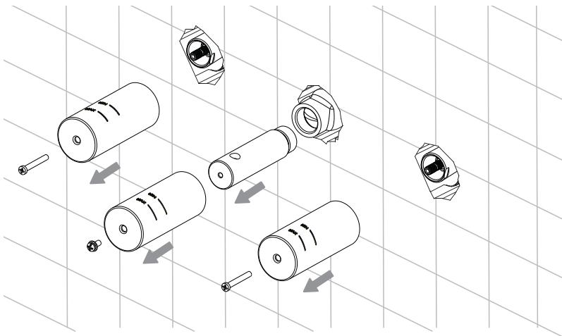
4.先取出把手组，用附带的内六角扳手逆时针旋转把螺钉拧出，依次把垫片、锁紧螺母取出。
