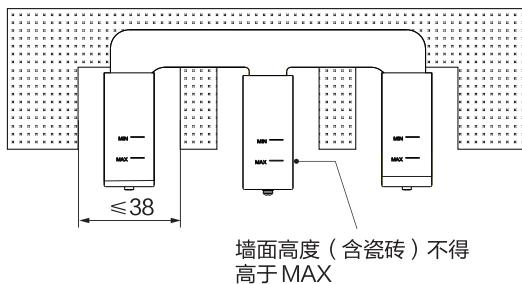
3.墙面瓷砖等装饰完成后，取下预埋阀体组上的保护套。
