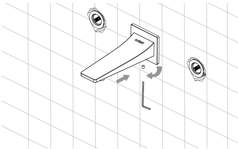
7.取出热把手（红色标识），将把手组插入接头后用附带的内六角扳手旋紧螺丝。使用相同的方式安装冷把手组（蓝色标识）。注意顶丝孔位下下方，且冷、热把手在关闭状态下，目测大致处于水平方向。
