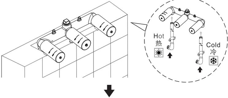
2. 确认各连接处没有渗漏后，用水泥等填料将预埋阀体组固定到墙内。保护套周围要留一定的空间以防后续安装中无法拆下。
