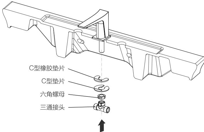
3. 取热把手组件（红色标识），将把手组取下，然后顺时针旋转热阀芯到关闭状态，根据台面厚度调整安装螺母位置。
