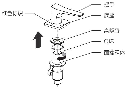
4. 将热阀体组从台面下左侧安装孔从下往上穿入台盆，O环装入高螺母，从台盆上与热阀体组旋紧。调整好阀体组方向，用工具将台下安装螺母旋紧。
