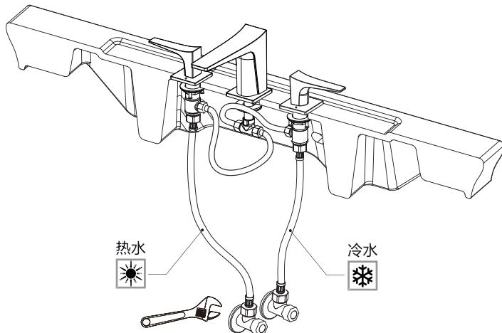
10.安装完毕后，开启水源，反复检查各衔接处是否渗漏，确保正常后方可使用。
