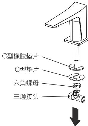
2. 将出水嘴插入台面中间的安装孔内，从台面下依次将C型胶垫片、C型垫片、六角螺母、三通接头依次安装上，并用活动扳手旋紧锁紧螺母。
