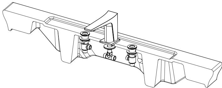
6.按下图所示，将冷、热阀体组的出水口与水嘴组进水口通过编织软管相连锁紧。
