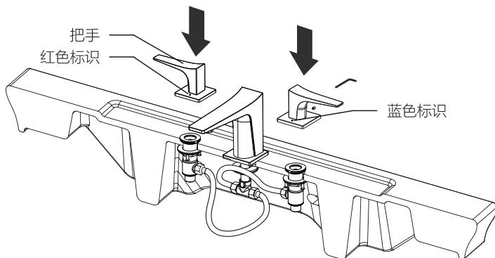
8. 检查角阀是否正常出水，放出适量的清水清洗管道，并确认左边为热水，右边为冷水。
