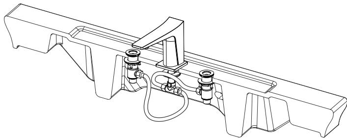
7. 安装热把手（红色标识），用附带的内六角扳手旋紧，再使用相同的方式安装冷把手（蓝色标识）。注意顶丝孔朝后，且冷、热把手在关闭状态下，目测处于水平方向，如有偏差，请调整台下组件。
