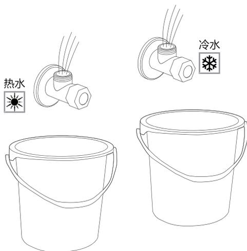
8. 安装完毕后,开启水源,反复检查各衔接处是否渗漏,确保正常后方可使用。
