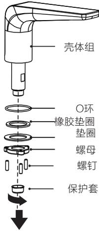
2. 将龙头组体插入台面中间的安装孔内，从台面下依次将O环、橡胶垫圈、垫圈、螺母、螺钉及保护套安装到壳体组螺纹上并用可调节扳手锁紧。
