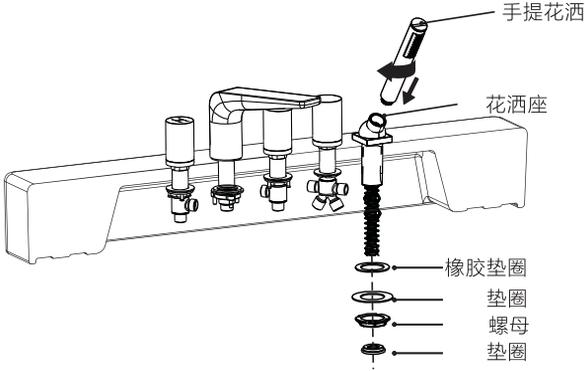
6. 安装好把手组后，按下图所示，将冷、热阀体组的出水口与切换阀组进水口相连锁紧，切换阀组出水口与龙头本体及手提花洒组相连锁紧。
