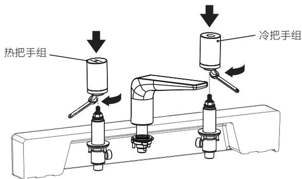
4.安装好把手组后，按下图所示，将切换阀组从台面下安装孔从下往上穿入，调整好切换阀组方向，固定位置后，用可调节扳手锁紧。
