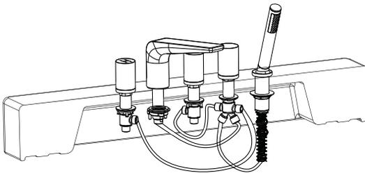
7. 检查角阀是否正常出水,放出适量的清水清洗管道,并确认左边为热水,右边为冷水。
