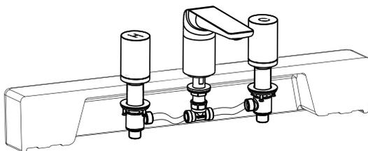
5. 检查角阀是否正常出水，放出适量的清水清洗管道，并确认左边为热水，右边为冷水。
