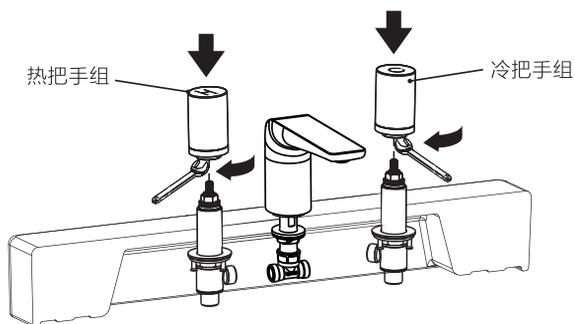
4.安装好把手组后，按下图所示，将冷、热阀体组的出水口与水嘴组进水口相连锁紧。
