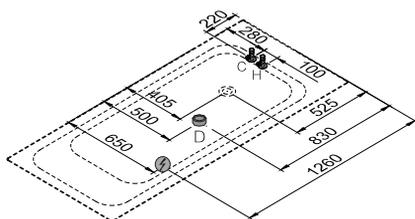
⚡：预留电缆 D：地面排污口  $\varnothing 50$  C、H：冷、热水进水口
