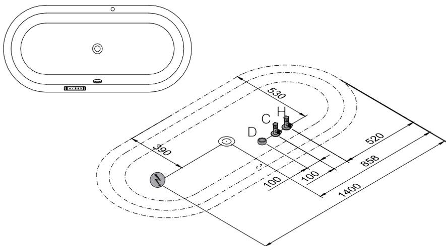
⚡：预留电缆 D：地面排污口  $\varnothing 50$  C、H：冷、热水进水口
