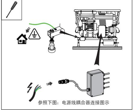
**7** 电源线耦合器连接图示
