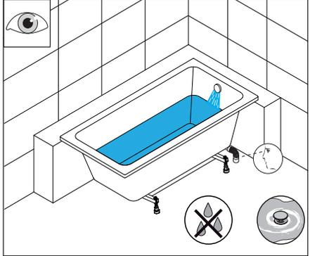
**9** 渗漏检查：喷嘴、接管处是否漏水（放置20分钟）。
