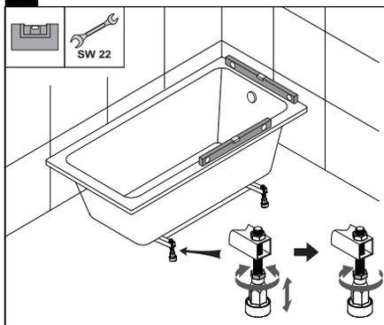
**3** 靠墙面砌砖：支撑墙面距离浴缸边缘20-30mm。
