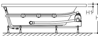
**4** 浴缸下水器排水管连接：将浴缸下水器排水管插入地面排污口内，用玻璃胶密封，防止漏水。
