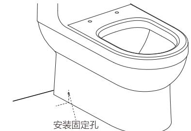
6.首先将进水管与产品进水阀连接，恰当拧紧。然后将坐便器靠近安装墙慢慢放下，使坐便器排污管套头牢固套进移位器套头。
