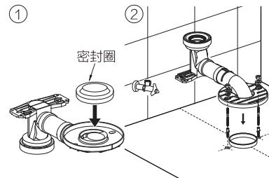
5.如图所示，作好标记，分别钻 $\varnothing 10 \times 50\text{mm}$ 的孔，塞入膨胀套，放上7字块，注意竖边朝外，用地脚螺丝加垫圈，将7字块牢固的固定在地面，不得晃动；用干布将移位器与地面的接触面擦干净后，用防霉密封胶均匀涂抹。
