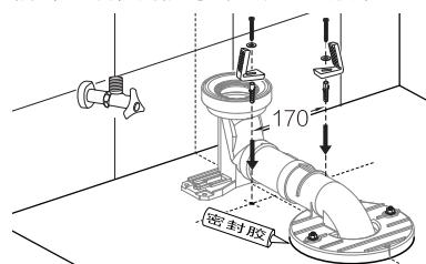
2.首先将移位器与地面横向、纵向中心线保持对齐，然后在做打孔标记；安装进水角阀，建议水管安装孔朝上。
