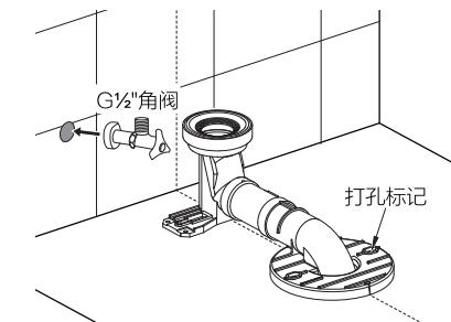
4.首先将坐便器排污管牢固套进移位器套头，建议坐便器背面与墙面留有25mm距离给供水软管通过；在安装固定孔中心，引垂直线到地面作标记，最后移出坐便器。
