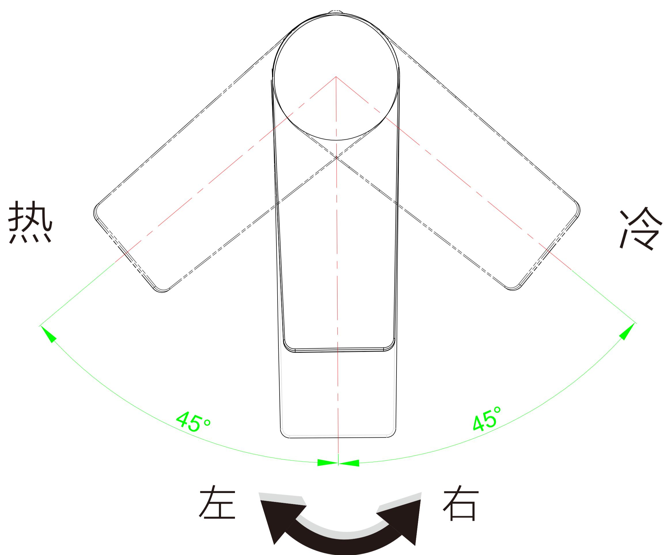
如图所示,面向产品,把手向左打开,随着打开角度变大,出水口水温变大,当角度达到45度时龙头为全热状态;把手向右打开,随着角度变大,出水口水温变小,当角度达到45度时龙头为全冷状态。
