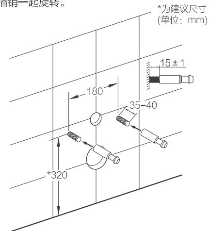
4.抬起坐便器往墙体靠拢，使进水管插入墙体出水口、锁紧器插销插入坐便器安装孔内、墙体排污管套住坐便器排污管。
