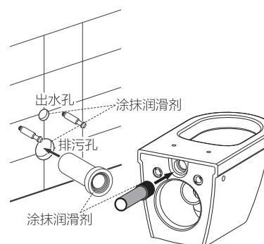
2.先依照选定的入墙水箱之说明书安装好架体及完成墙面，依照标示尺寸旋入锁紧插销。
