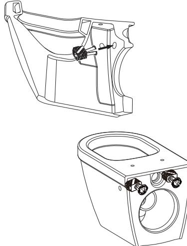
3.参考入墙水箱中的安装说明书，裁剪好进水管及排污管的长度，然后将进水管插入坐便器进水孔内，排污管插入墙体排污孔中。
