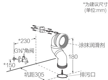
2.首先将坐便器排污管牢固套进移位器套头；在安装固定孔中心，引垂直线到地面作标记，最后移出坐便器；将靠近角阀一侧的装饰盖取下，将进水软管从孔眼穿出。
