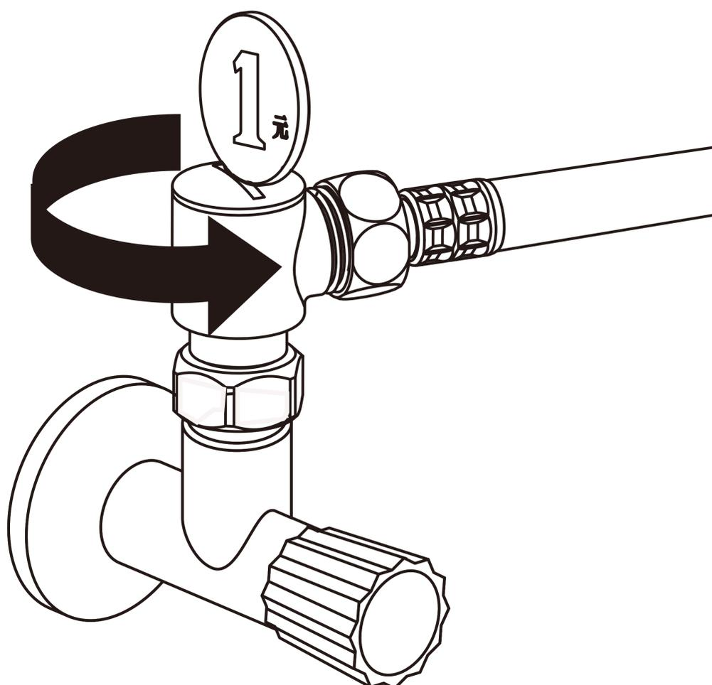
3.取出过滤网使用清水进行清洗，清洗后逆序装回。
