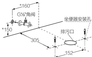
4.如图示，先把密封圈套入坐便器排污口；再将坐便器排污口对正地面排污口套下，轻微摇摆压紧。
