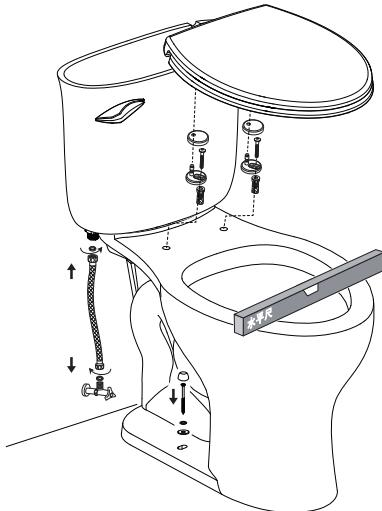
6.打开角阀进行冲水试验，检查各连接处无漏水现象后，盖上水箱盖；清理后，于底部均匀涂抹一圈密封胶，完成安装。
