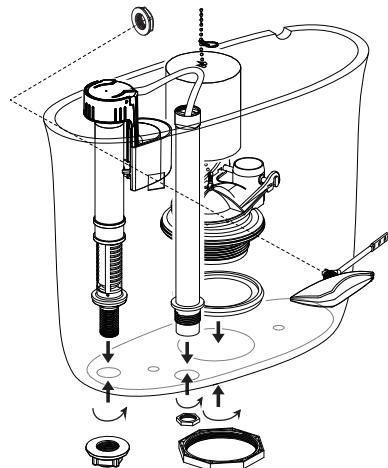
2.首先安装AST单向阀（已装好），再将水箱密封圈吻合套住排水阀底部，然后把水箱放在底座的水箱安装面上，将螺钉穿过水箱及底座安装孔，并将其螺母拧紧。
