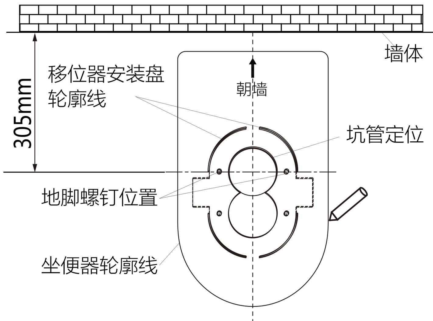
2.用电钻在地脚螺钉标记处分别钻一个 $\Phi 10 \times 55 \text{mm}$ 的孔，装上塑料膨胀栓（ $\Phi 10 \times 50 \text{mm}$ ）和地脚螺钉（ $M8 \times 36 / ST7.5 \times 46 \text{mm}$ ）。
