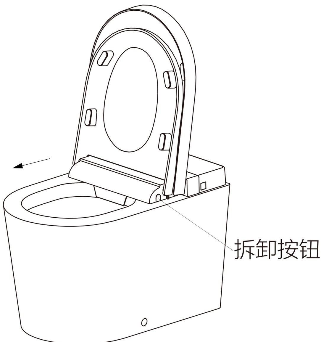
12.在陶瓷上方垫上软布，轻轻抬起坐便盖，翻转后平放在软布上，卸下电池仓盖，按正负极方向正确安装电池。
