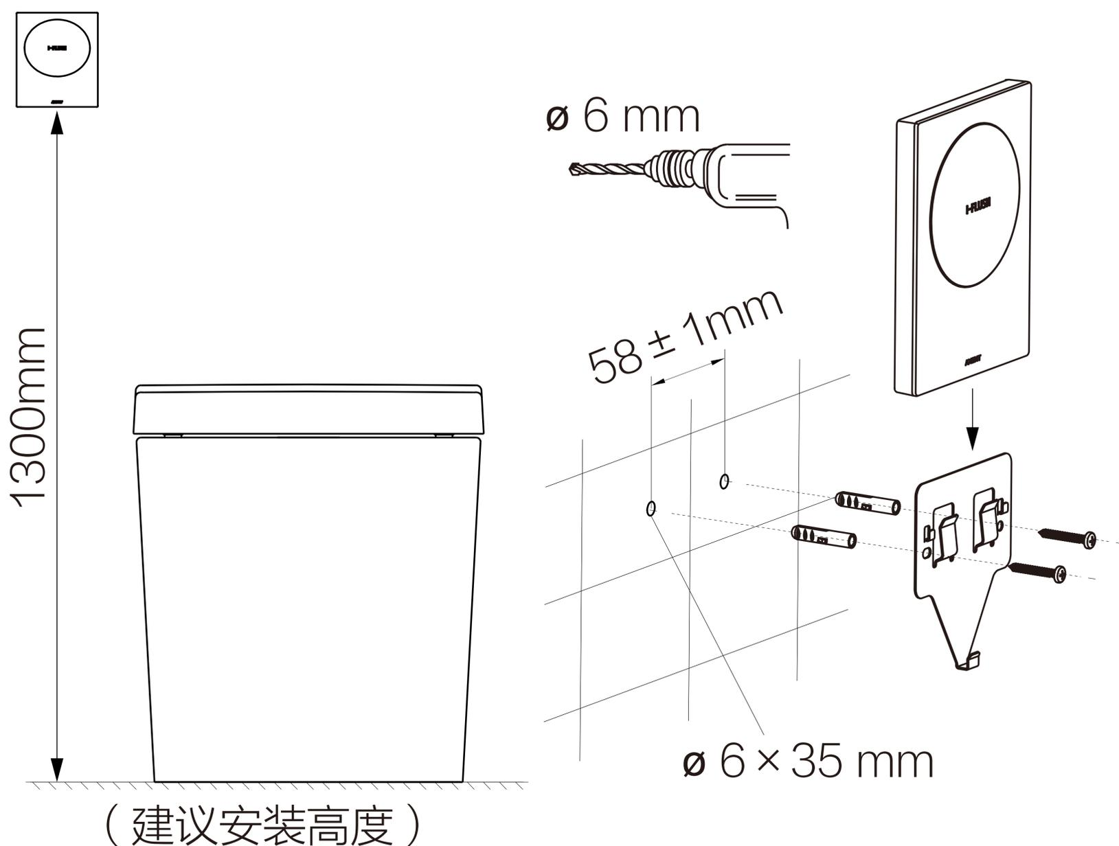
17. 坐便器在公共场合使用时，请安装遥控器防盗销。使用针状物拨动防盗销底部小孔顺时针或者逆时针约  $65^\circ$ ，即可将遥控器固定在支架上。
