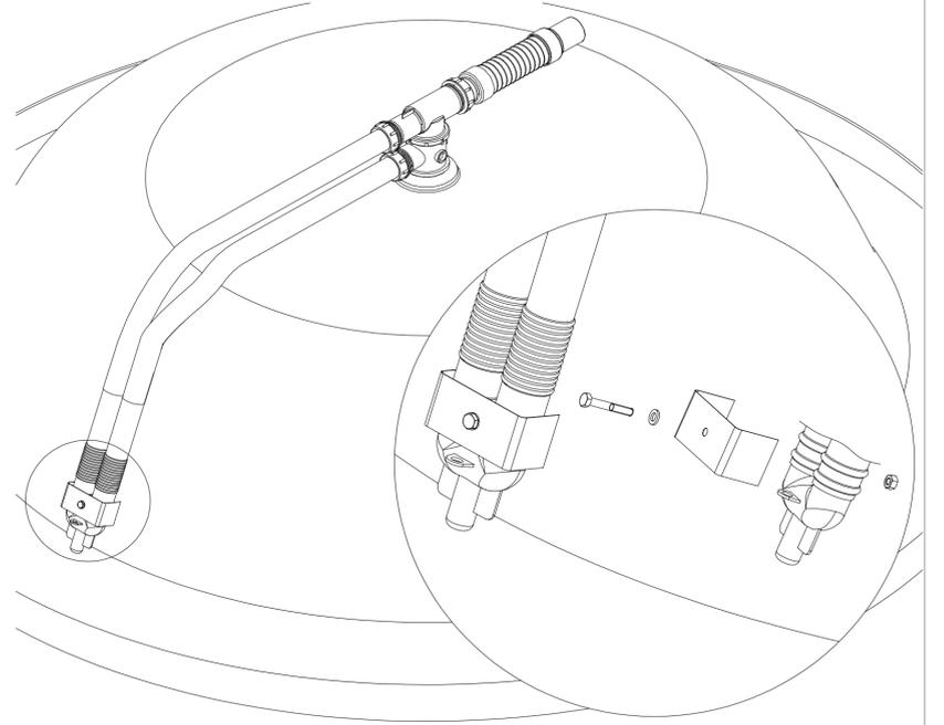
5 连接排水软管：将排水软管插入地面排污口内，用玻璃胶密封。
