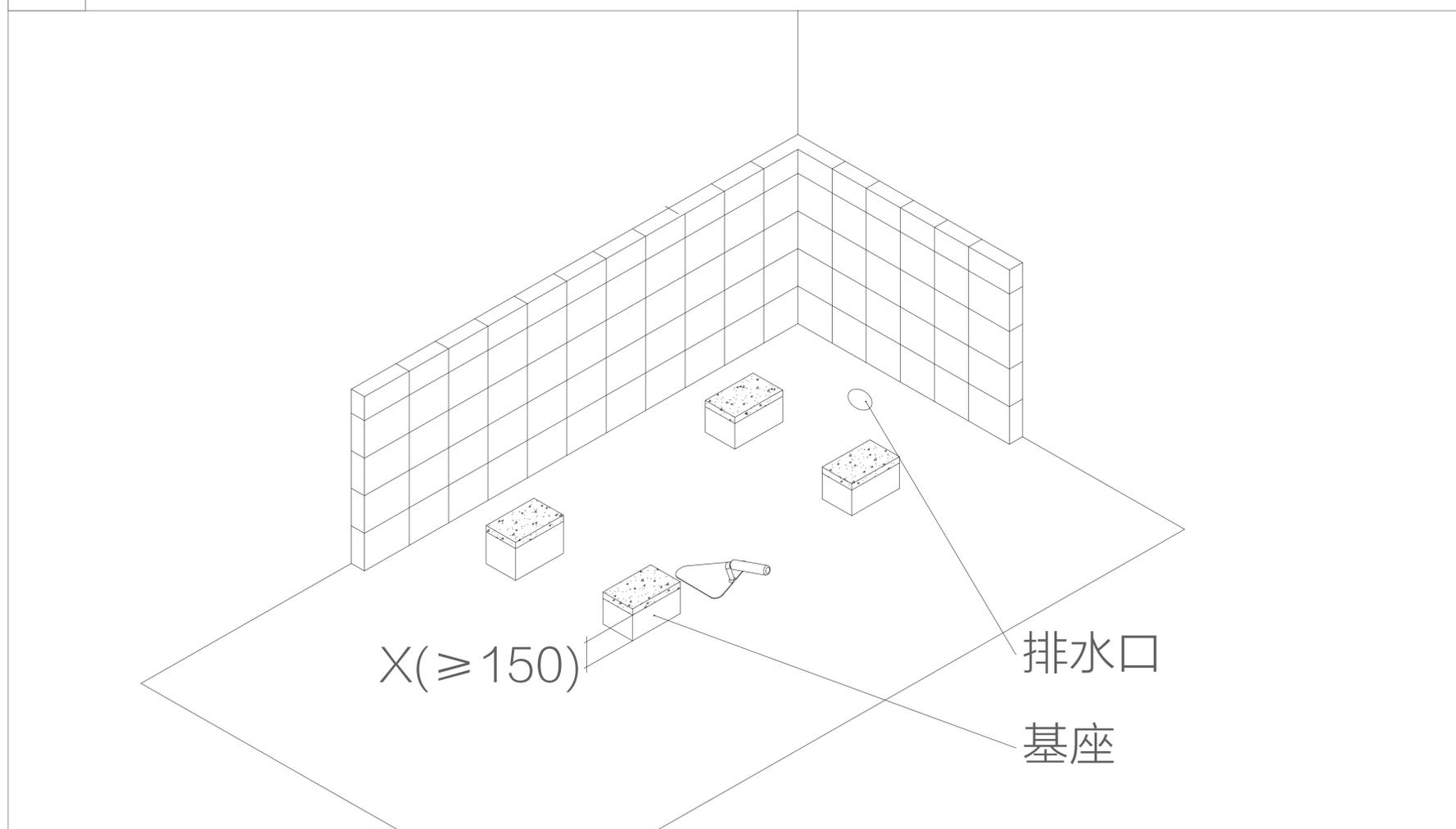
4 安装排水件：根据所购浴缸排水配件安装说明将排水配件安装好。
