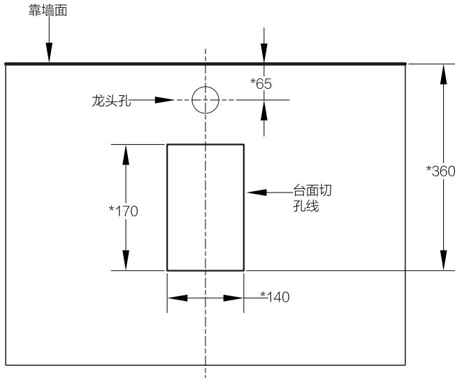
请确认龙头类型后，进行模拟安装并预留足够的安装空间，参照龙头安装说明书进行安装。
