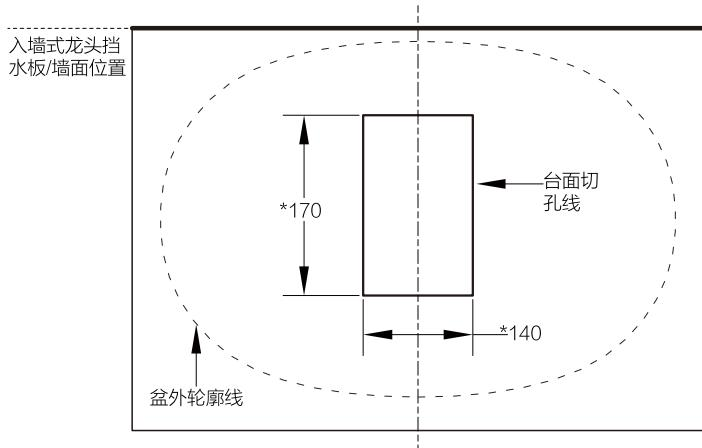
请确认龙头类型后，进行模拟安装并预留足够的安装空间，参照龙头安装说明书进行安装。
