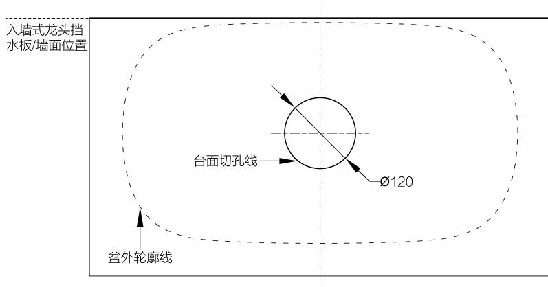
请确认龙头类型后，进行模拟安装并预留足够的安装空间，参照龙头安装说明书进行安装。
