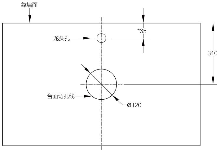
请确认龙头类型后，进行模拟安装并预留足够的安装空间，参照龙头安装说明书进行安装。
