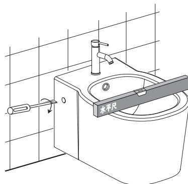
5. 参照排水组安装说明书安装排水组，然后套入侧边安装装饰盖。
