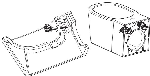
2. 先依照产品尺寸安装好架体及完成墙面，依照标示尺寸旋入锁紧插销。
