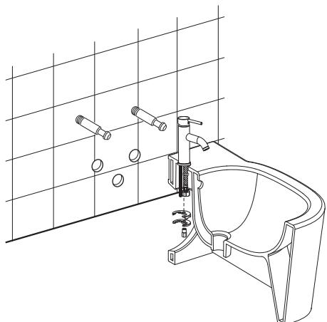
4. 保持住对妇洗器往墙体推托的动作，然后用一字螺丝刀通过侧边安装孔，将锁紧器稍微旋紧，调整水平，最后旋紧。
