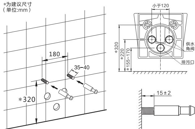
3. 参考龙头安装说明书，将龙头安装好，然后抬起妇洗器往墙体靠拢，使锁紧插销插入妇洗器安装孔内。（龙头不随货供应）
