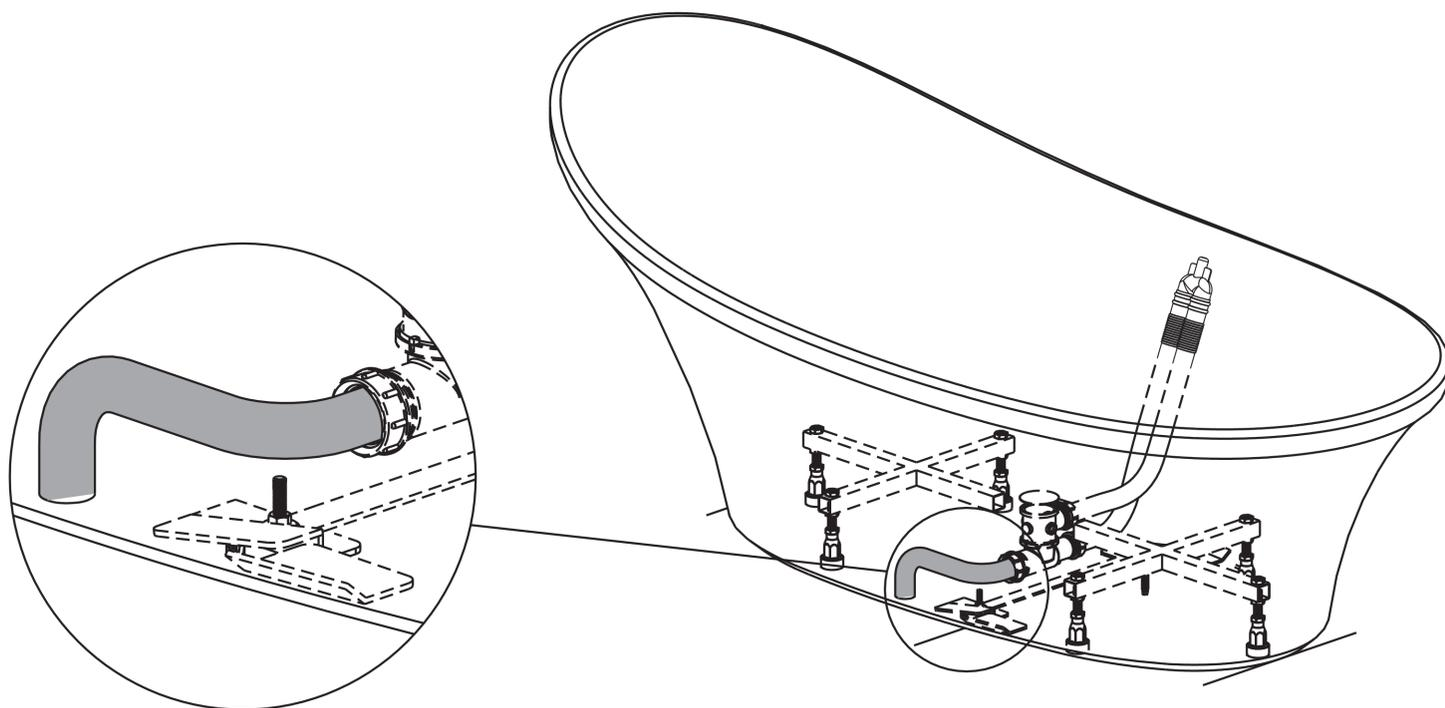
注意: 排水配件插入排水管部分至少大于等于50mm以上, 且所有连接要紧密, 以防止漏水.
