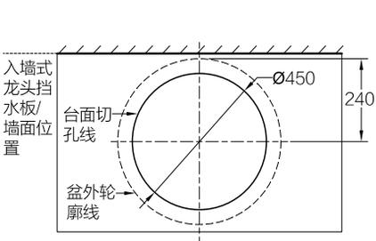
请确认水龙头类型后，模拟确认摆放位置，再进行台面切孔，并参照水龙头安装说明书进行安装。
