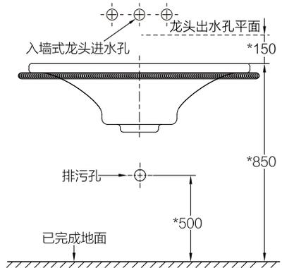
盆与台面配合安装范例（注：以下产品安装图为示意图，具体以实物为准）
