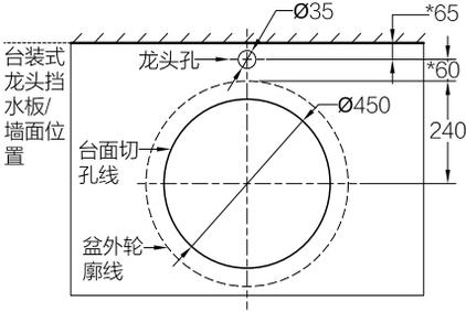
请确认水龙头类型后，模拟确认摆放位置，再进行台面切孔，并参照水龙头安装说明书进行安装。
