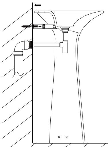
3.如图所示,安装落地盆直角固定架。
