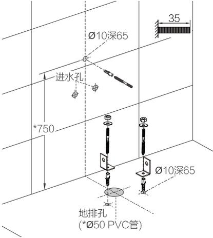
5-2.墙排安装如图示，安装锁墙螺栓组及落地盆直角固定架。
