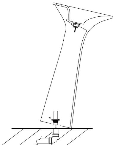
2.将落地盆向墙体推进。依次将垫片、螺母套入锁墙螺栓，适当拧紧。
