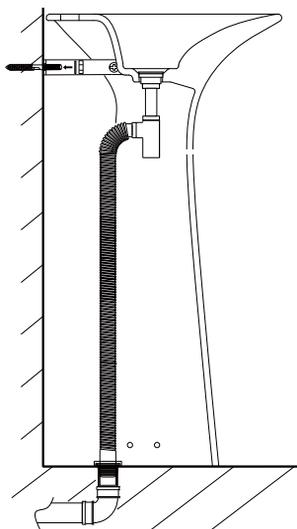
4.如图所示，安装落地盆直角固定架。
