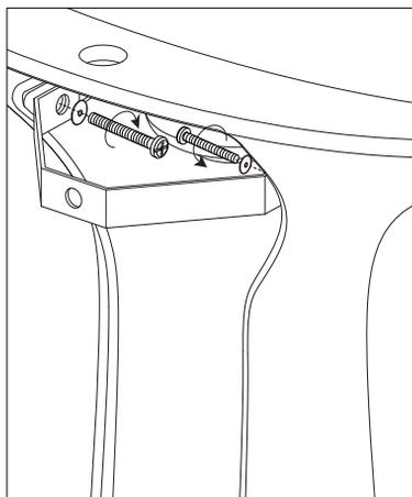
3.将落地盆放置合适安装位置后，将直角固定架对准盆的安装孔（若为地排安装，则选择固定架不与地排孔干涉的安装孔）模拟位置，在地面标示出打孔位置。
