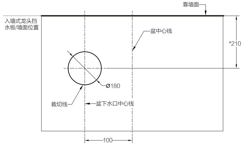
请确认龙头类型后，进行模拟安装并预留足够的安装空间，参照龙头安装说明书进行安装。
