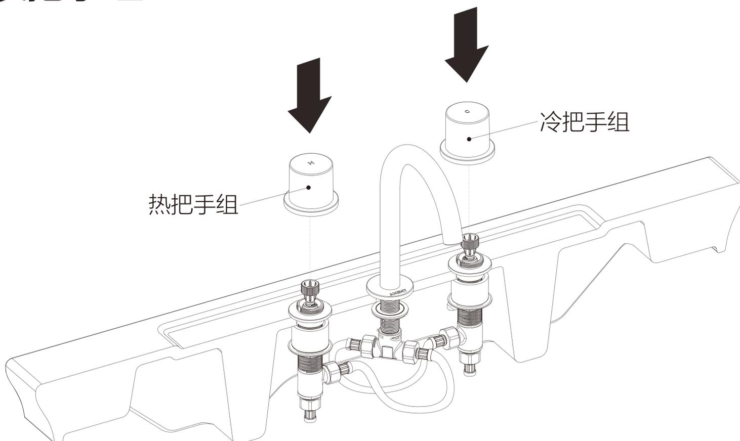
注：将冷热把手组的防滑筋条朝后，插入冷热阀芯，之后用手旋紧法兰。
