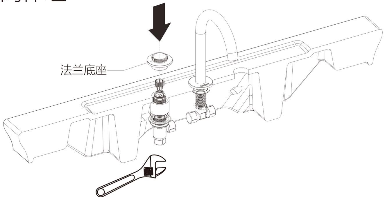
注：从台下插入阀体在左安装孔中，从台上旋紧法兰底座，再用活动扳手将台下安装螺母旋紧。
