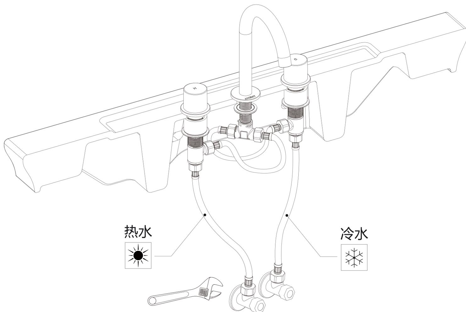
注：准备两根G1/2螺母的进水软管，将热阀体组的进水口与热角阀相连，冷阀体组的进水口与冷角阀相连。
