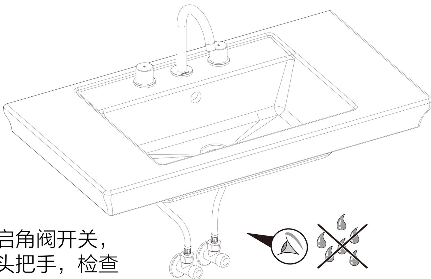
注：开启角阀开关，旋转龙头把手，检查各个部件是否出现漏水现象；左右把手依次转动90度，检测全冷全热是否正常。
