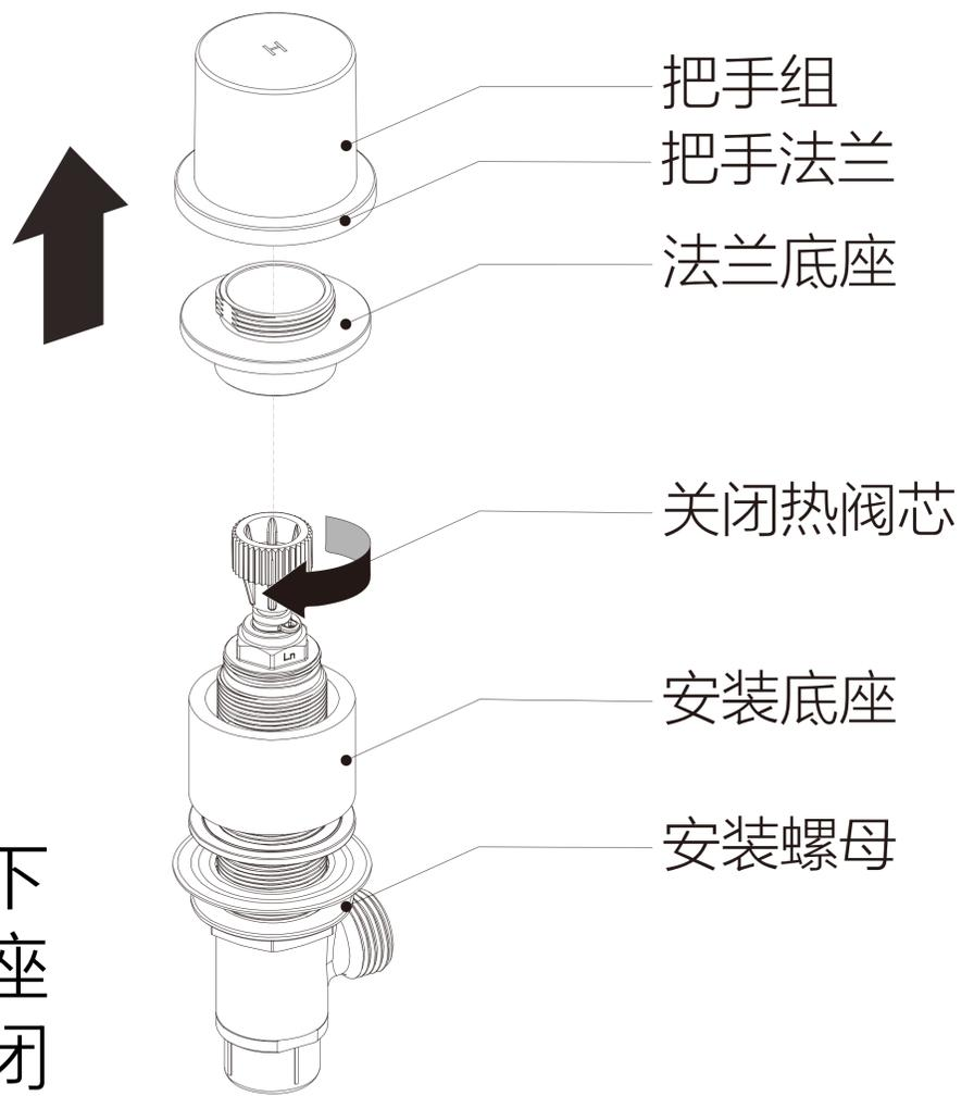
注：旋转把手法兰，取下把手组，再旋下法兰底座，顺时针旋转阀芯到关闭状态。
