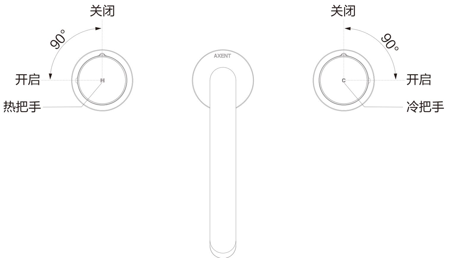
如图所示,面向产品,左边把手打开出热水,随着打开角度变大,出水口水温变大,当角度达到90度时龙头为全热状态;右边把手打开出冷水,随着角度变大,出水口水温变小,当角度达到90度时龙头为全冷状态。
